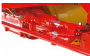
Hydraulicznie dwustronnego działania Modele HIT AZ
