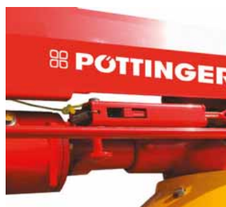
Mechaniczna regulacja biegu po skosie w HIT NZ – przez linkę obsługiwaną z kabiny ciągnika.
