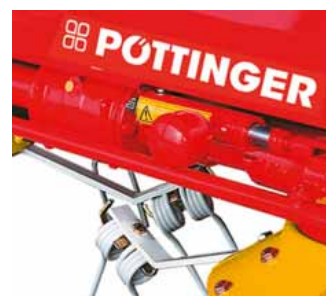
Hydrauliczna regulacja biegu po skosie w HIT AZ (opcja w NZ) odbywa się przy pomocy siłownika hydraulicznego jednostronnego działającego wyposażonego w zbiornik gazu.
