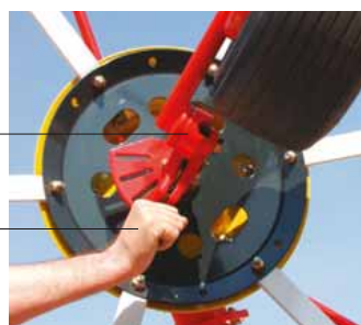
Przestawienie ręczne w modelach HIT N i HIT A
