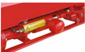
Hydraulicznie jednostronnego działania Modele HIT NZ
